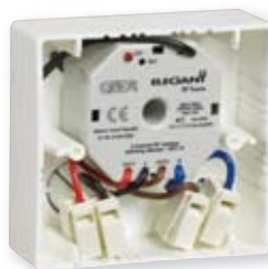
Montáž přijímače do instalační krabice pro povrchovou montáž
